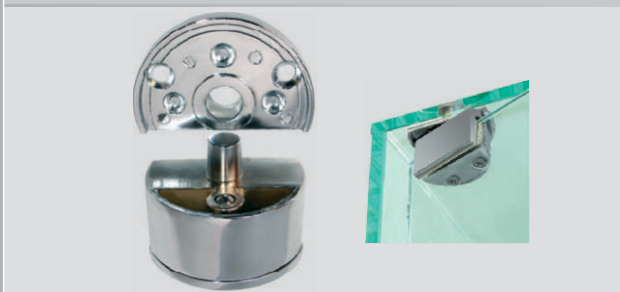
Dobradiça Meia Lua par com esferas permite várias posições de parada. Vidros de 4 a 6 mm - carga max. 20 kg. 01.34.005
